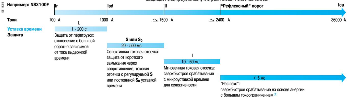
(1) Эта система отключения полностью независима от расцепителя. Воздействуя непосредственно на механизм, она на несколько миллисекунд опережает действие расцепителя.
